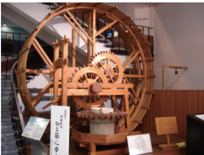
人車製薬機。大きな輪の中に入った2人が足踏みすることで、歯車が連動して石臼が廻り薬草を粉にする
