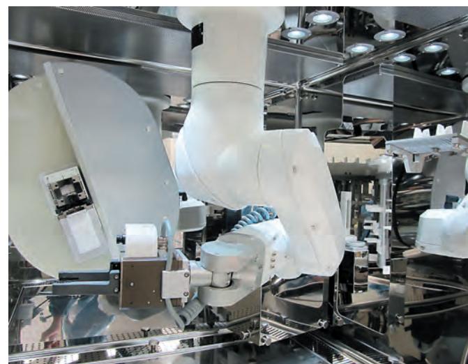
抗癌剤専用自動調製装置。閉鎖環境でロボットアームが高精度の調製を行う
