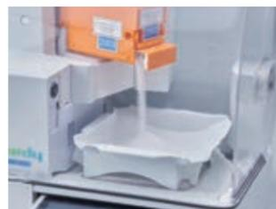
どなたでも正確な秤量業務。散薬カセットから直接自動で秤量するため、どなたでも正確に業務を行えます。
