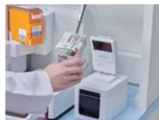
散薬カセットへの薬品補充も安全に。薬品補充の際は散薬カセットのRFIDチップと、充填対象のGS1データバーによるダブルチェック。異なる薬品の混入間違いを防ぎます。
