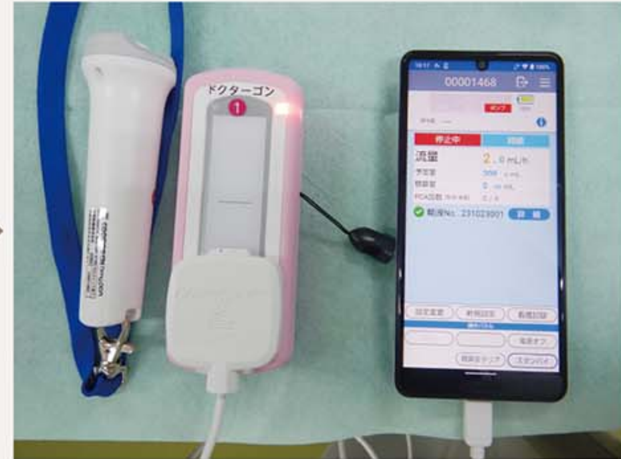
● 手順8 流量の設定～ドライブユニットへの転送 コントローラのアプリを起動すると、ドライブユニットが自動的にONになるので、コントローラで流量などを設定し、ドライブユニットに転送する。
