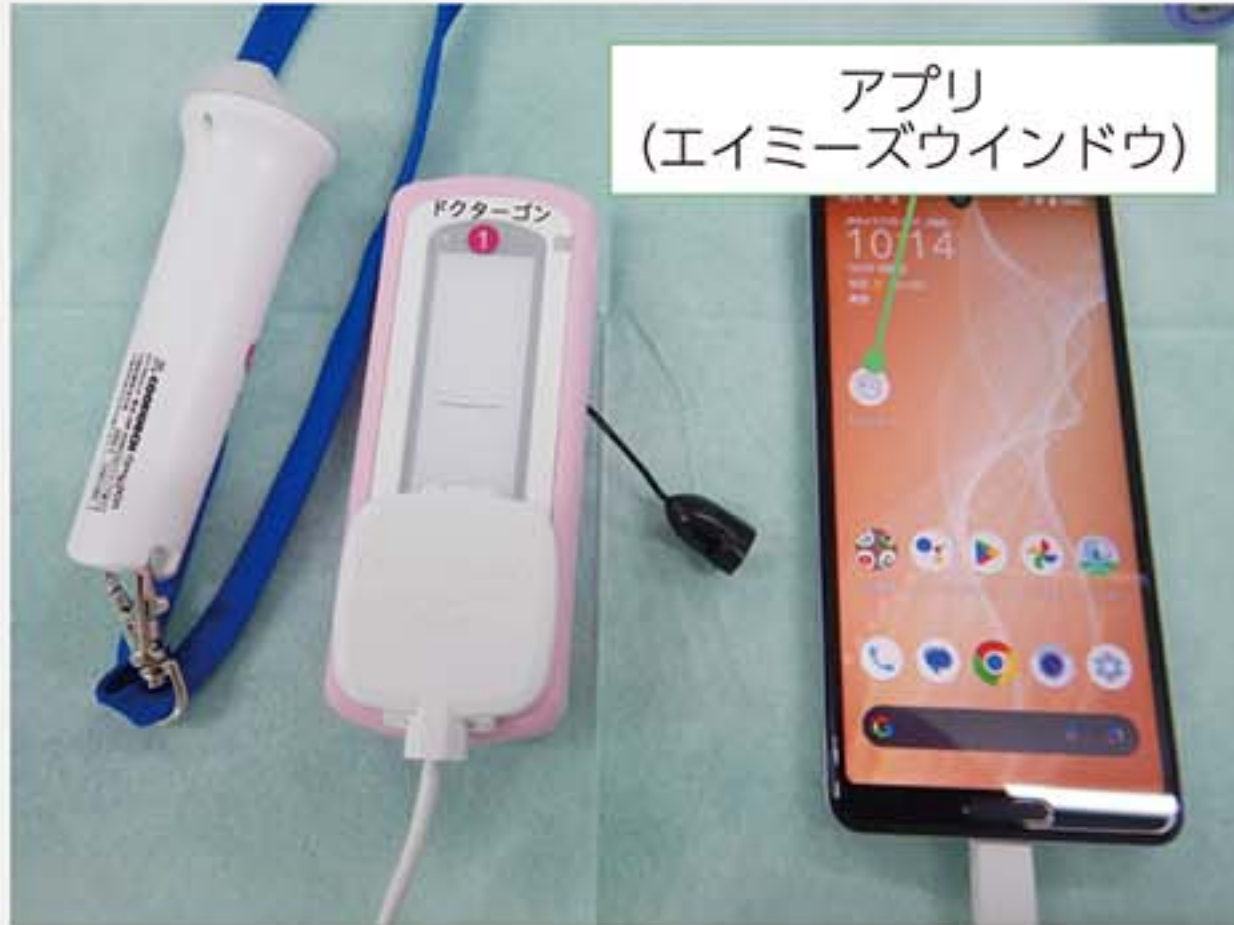
● 手順7 アプリの起動 コムタッチをコントローラにUSB接続し、ドライブユニットにマグネットを装着してアプリ(エイミーズウインドウ)をタッチして起動する
